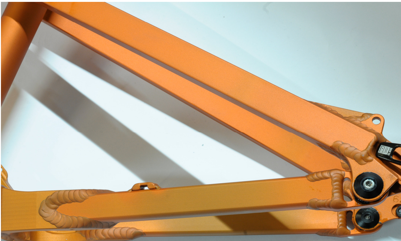
Farbverlauf auf einem Bauteil (Schwinge) / colour shadows on one frame part (swingarm)
