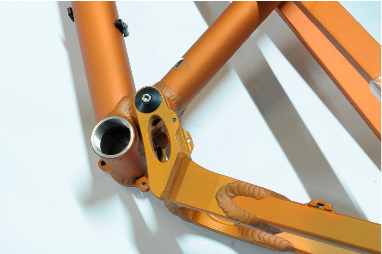
Unterschied einer orange eloxierten Schwinge und Hauptrahmen / difference between orange colour on a swingarm and a mainframe
